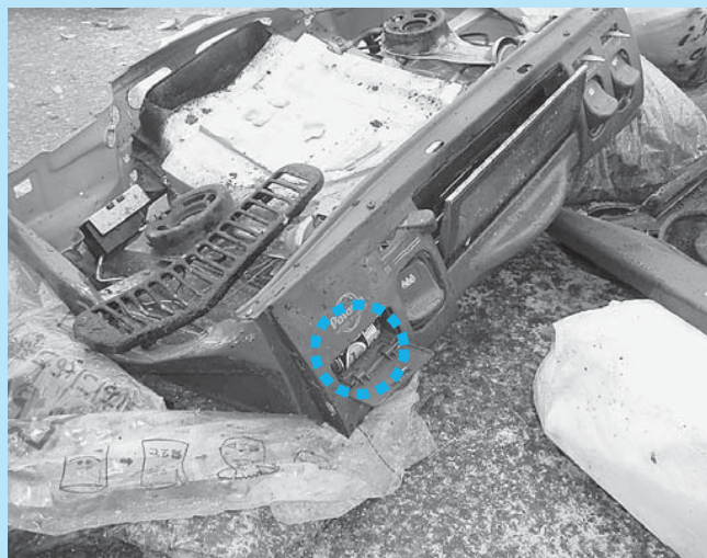
▲電池が入ったままのガスコンロ。点火スイッチが押された状態でパッカー車から出してきました。
