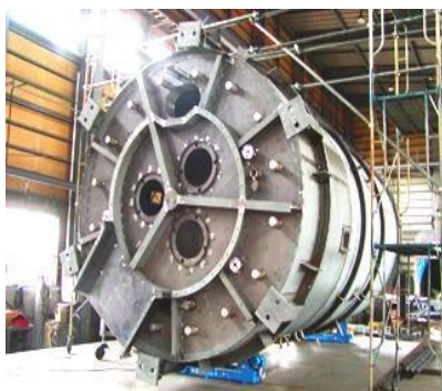
石油精製向け加熱炉
