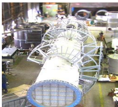
排煙処理塔（SUS316L）
