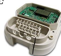
ガスメーター
