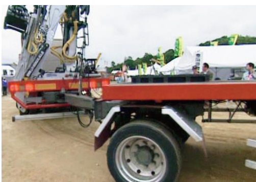
油圧操舵機能でバックがラクラク！
