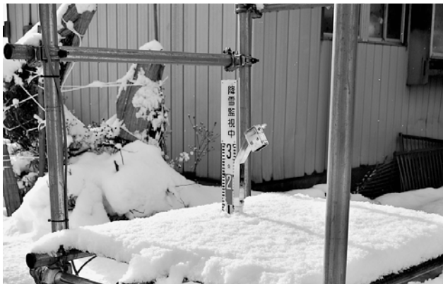
▲市内三カ所に設置された除雪自動通報装置
