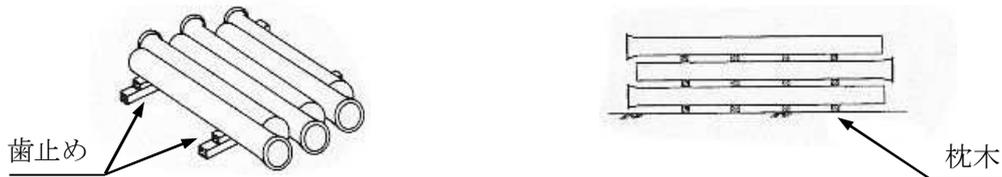
4. 取扱いは、台棒、角材等を敷いて直接地面に接することがないようにし、吊り上げる場合は台付けを確実に取ること。
