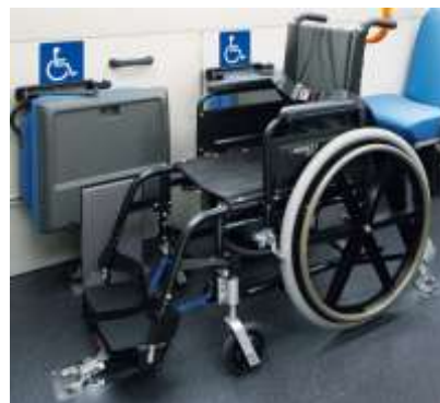
自動巻取り式車いす固定装置 ※ベビーカーの設置も可能
